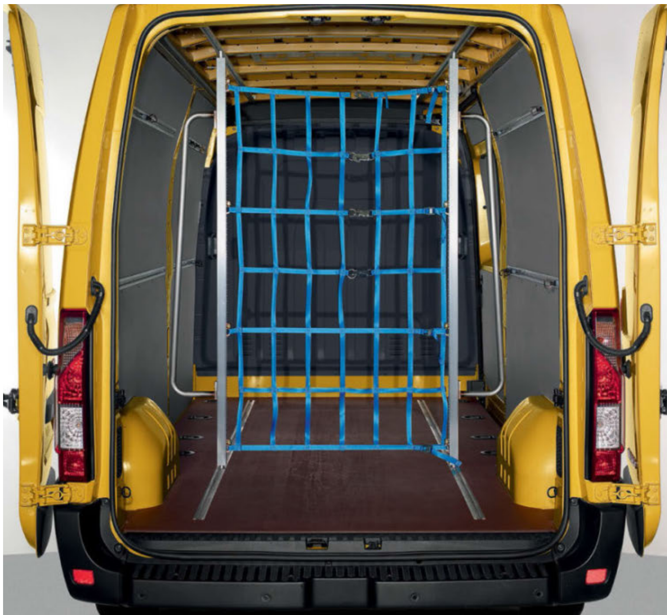
Ruchoma przegroda. Przytwierdzana do podłogowych i sufitowych szyn mocujących w odstępach co 25 mm jest szczególnie przydatna do zabezpieczenia paczek i innych luźnych ładunków. Posiada funkcję drzwi w środkowej części.
