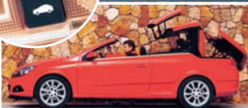
Elektryczne silowniki po wciśnięciu przycisku składają dach i szyby boczne w ciągu 36 s
