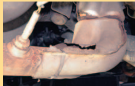
Układ wydechowy jest wrażliwy na korozję, ale nie ponadprzeciętnie
