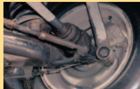
Czasem konieczna jest wymiana pękniętej osłony przegubu półosi napędowej
