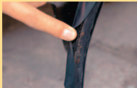
Rdza atakuje głównie krawędzie drzwi, a szczególnie ramy okien pod uszczelkami
