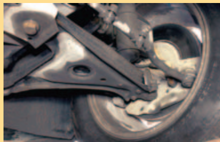
Elementy najczęściej psujące się w zawieszaniu to standardy, m.in. łącznik stabilizatora
