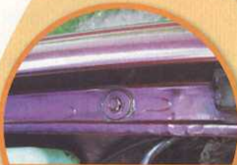
Po śrubach, którymi przykręcony jest przedni błotnik, widać, czy ktoś zdejmował go do malowania. Powinny być równomiernie pokryte lakierem fabrycznym, bez śladów odkręcania
