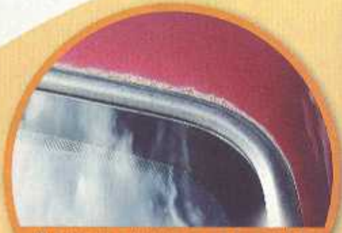
W niektórych autach korozja przy krawędziach mocowania szyb to typowa usterka, w innych – efekt malowania dachu. Zawsze jednak świadczy to nie o aucie oferowanym do sprzedaży
