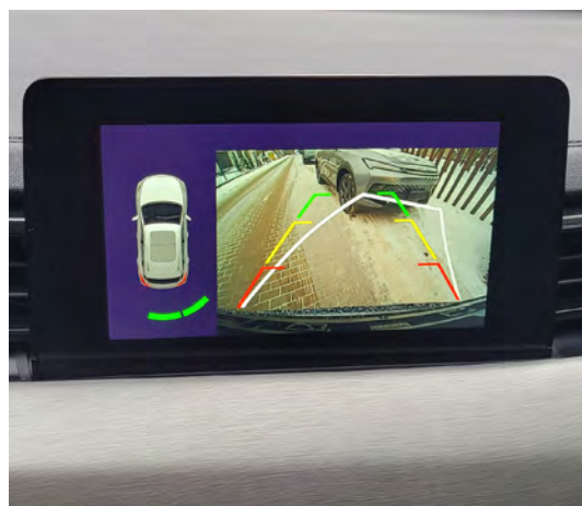
Kamera cofania z dynamicznymi liniami pomocniczymi
