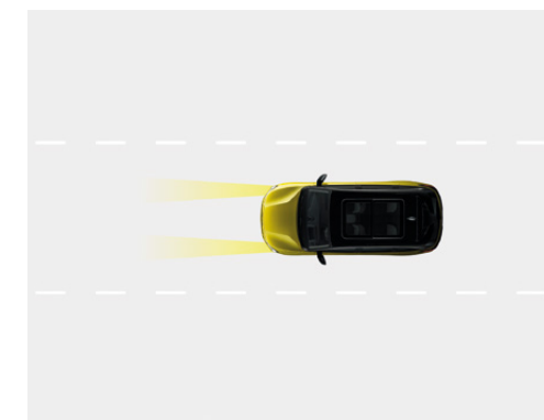
Automatyczne włączanie i wyłączanie świateł drogowych (HBA)
