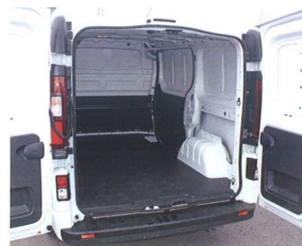
W standardzie sklejką wykończono jedynie drzwi tylne i boczne. Na podłodze zmywalna wykładzina.
