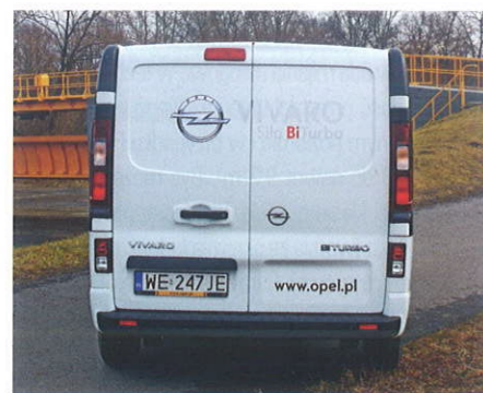
Tylne światła umieszczone są wysoko, co chroni je przed potencjalnymi uszkodzeniami.
