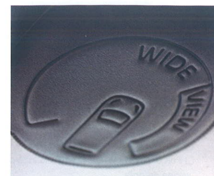
Paraboliczne lustro to sprytny patent: pozwala skutecznie walczyć kierowcy z martwym polem.
