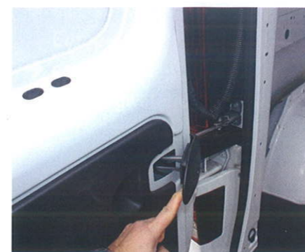
Tylne drzwi otwierają się pod kątem 90 lub 180°, co pozwala podjechać pod rampę załadunkową.
