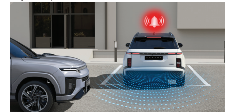
Asystent wykrywania ruchu poprzecznego z tyłu pojazdu
