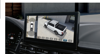
System kamer 360 stopni
