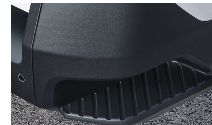
Stopień w rogu tylnego zderzaka ułatwiający dostęp do przestrzeni ładunkowej
