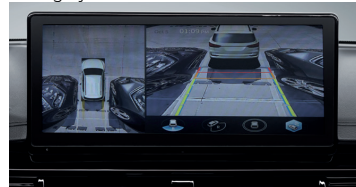
System kamer 360 stopni
