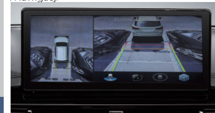
System kamer 360 stopni
