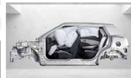
Solidna konstrukcja, 7 poduszek powietrznych
