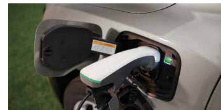
Kabel zasilający V2L
