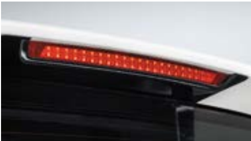
Tylne światło stop w technologii LED, umieszczone wysoko w spojlerze dachowym
