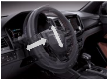
Regulacja pochylenia kolumny kierownicy w obu kierunkach
