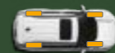
AWD z funkcją blokady (napęd na cztery koła z funkcją blokady - rozdziela po równo moc samochodu pomiędzy obie osie- do prędkości 40 km/h)
